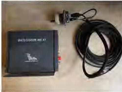
Figure 8 : Batlogger WE X1 avec micro MC32W
