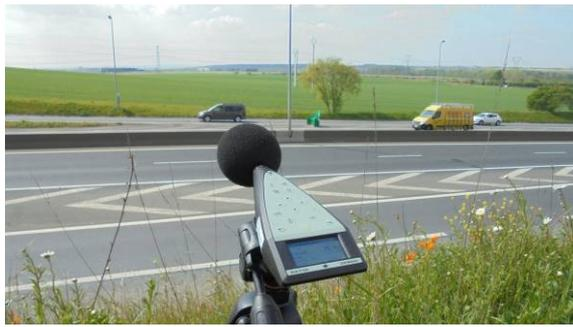
Point de mesure à 25 m de la RN 814 sur le merlon
