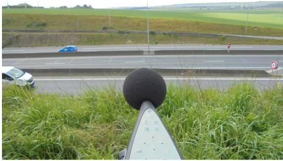
Point de mesure à 30 m de la RN 814 sur le merlon
