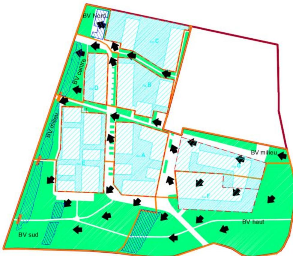
Plan 1 : Synoptique des bassins versants (avec le sens d'écoulement)
