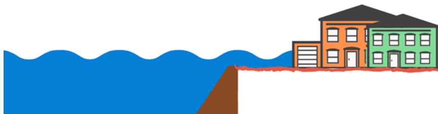
Fig. 1. Exemple de submersion (sans franchissement)
