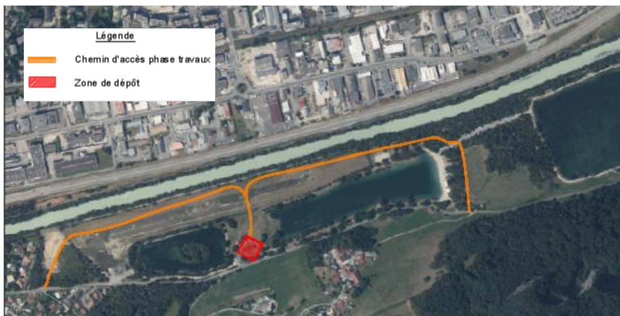
Figure 53 : Zone d'installation principale de chantier et axes de circulation principaux pour éviter la divagation des engins de chantiers
