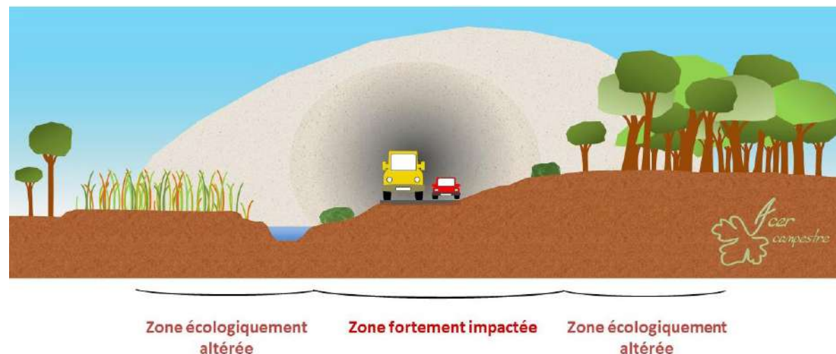
Illustration 15 : Répartition schématique des pollutions par le gaz, les poussières d'usure, le bruit, le mouvement et la lumière altérant la vitalité des milieux (d'après Office Fédérale des routes Suisse)
