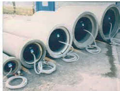
Figure 4 – exemple d'obturateur gonflable
