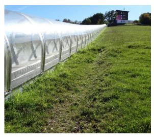
Exemple d'un tapis correctement raccordé au terrain naturel mais à la couverture réfléchissante
