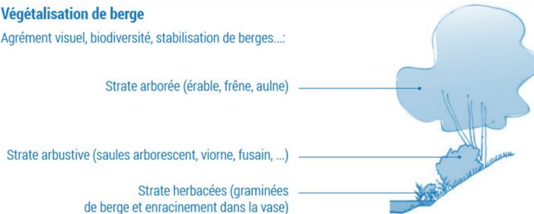
Exemple de végétalisation des berges
