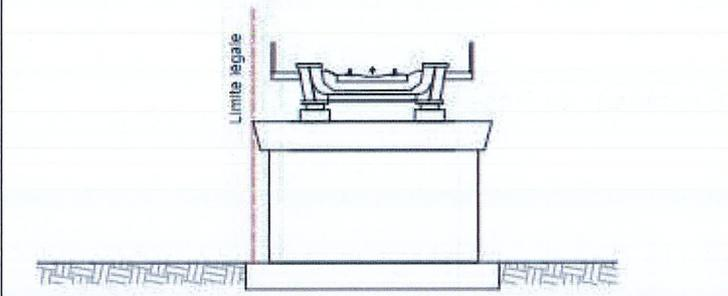
Ouvrage d'art aérien : voie ferrée portée par un pont-rail avec débord de tablier
