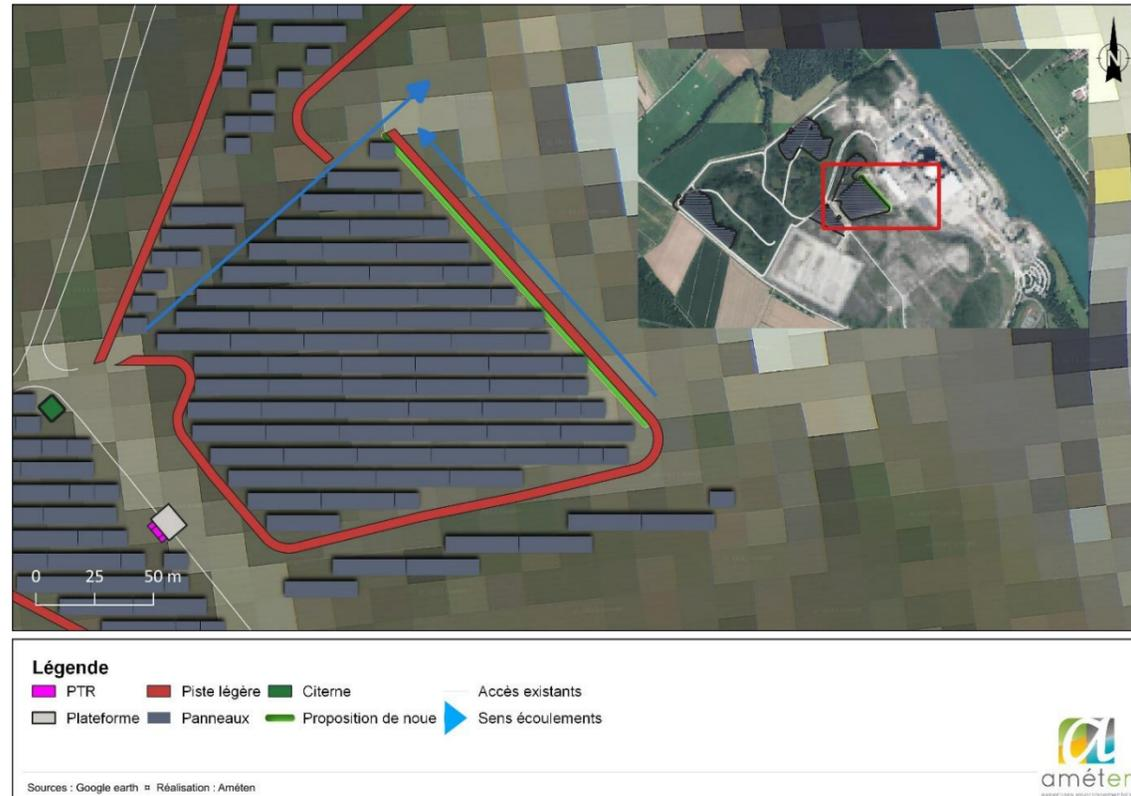
**Figure 40 : Proposition d'implantation d'une noue en périphérie de piste**
