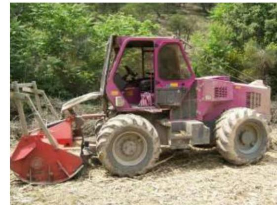
**Figure 44 : Exemple de tracteur équipé d'un broyeur forestier**
