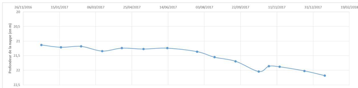
**Figure 63 : Evolution du niveau de la nappe sur 1 an au piézomètre au droit de la zone d'étude**
