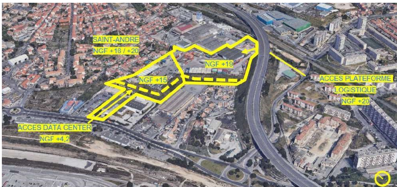
fig.27 : principe des terrassements (en pointillé : la nouvelle ligne de crête de la plateforme)
