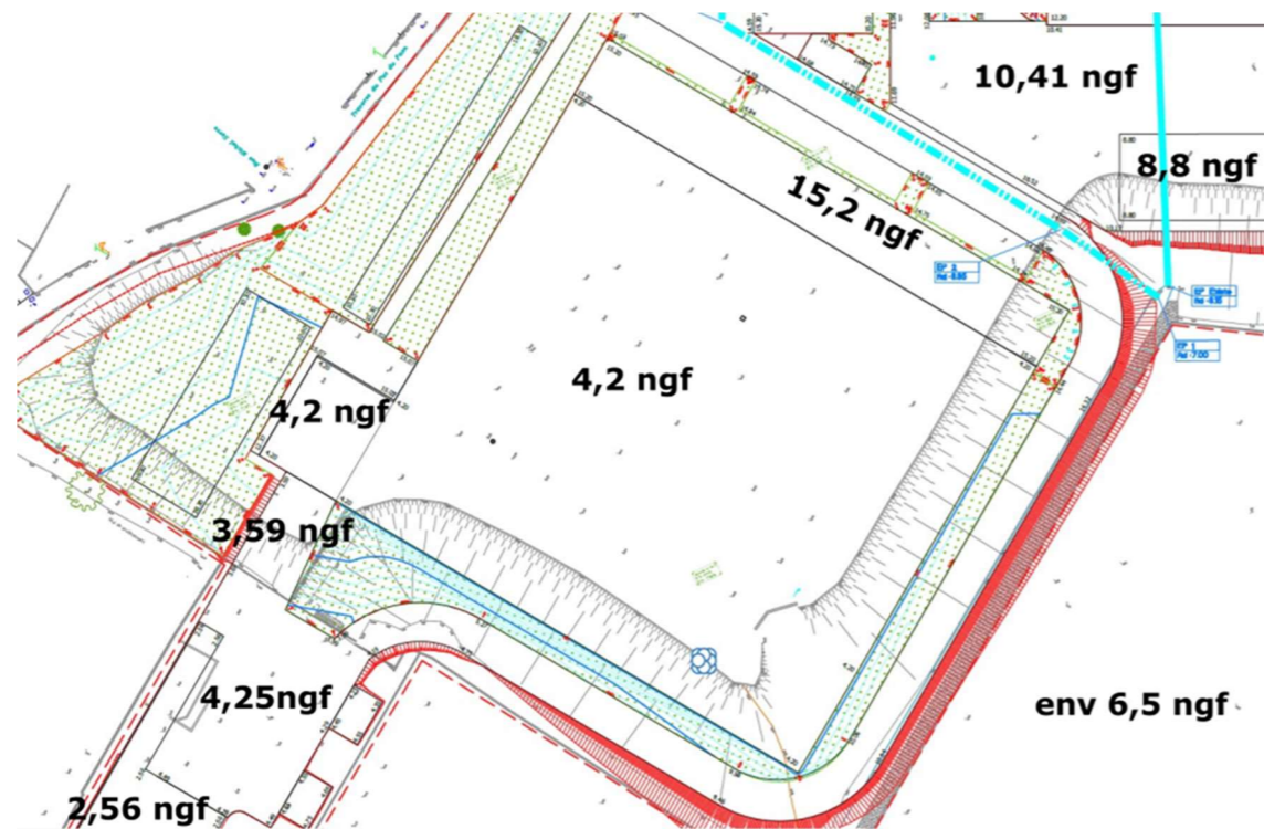
Figure 71 – terrassement du Datacenter
