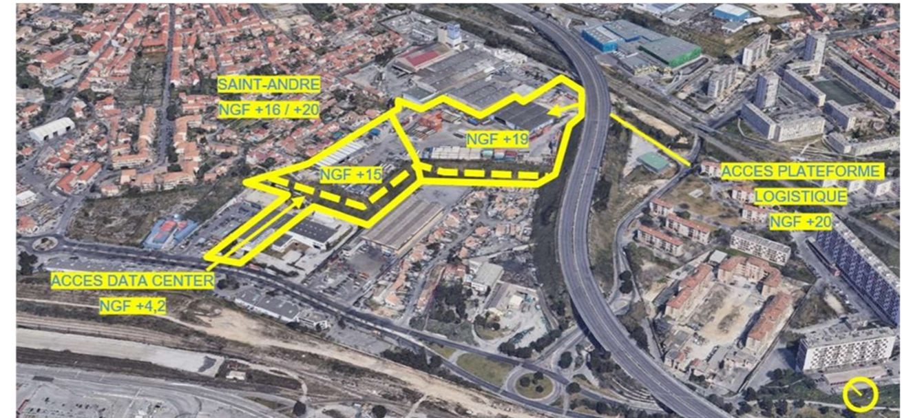
Figure 204 : principe des terrassements (en pointillé : la nouvelle ligne de crête de la plateforme)
