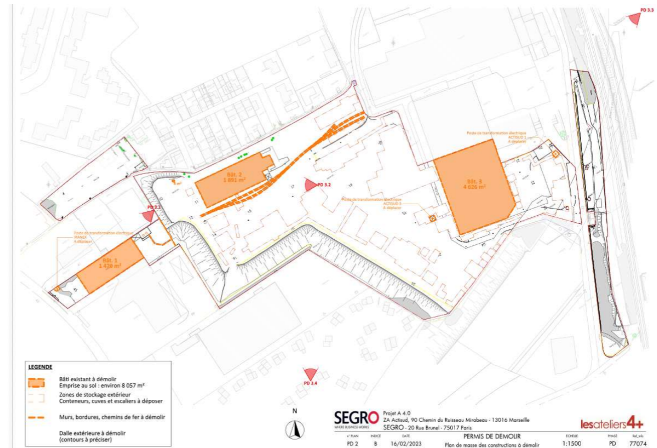
Figure 37 : Identification des bâtiments démolis
