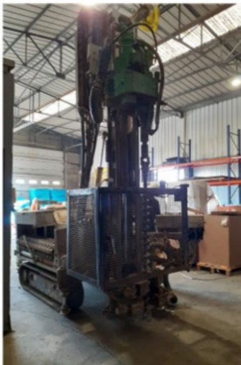
Figure 35 : Foreuse utilisée pour la réalisation des sondages
