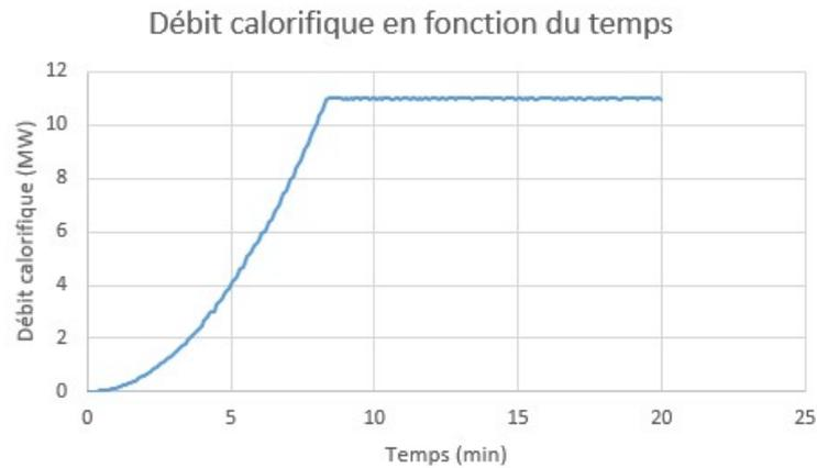
**Figure 10-10 : Evolution du débit calorifique en fonction du temps**
