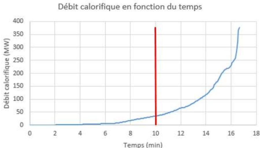
Figure 10-1 : Evolution du débit calorifique en fonction du temps
