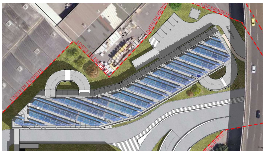
Panneaux photovoltaïques sur ombrière installée sur R+4 du Parking Silo
