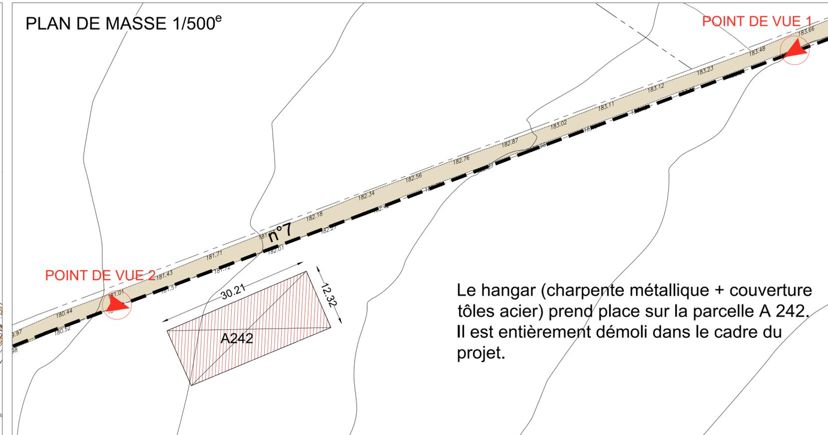
Le hangar (charpente métallique + couverture tôles acier) prend place sur la parcelle A 242. Il est entièrement démoli dans le cadre du projet.
