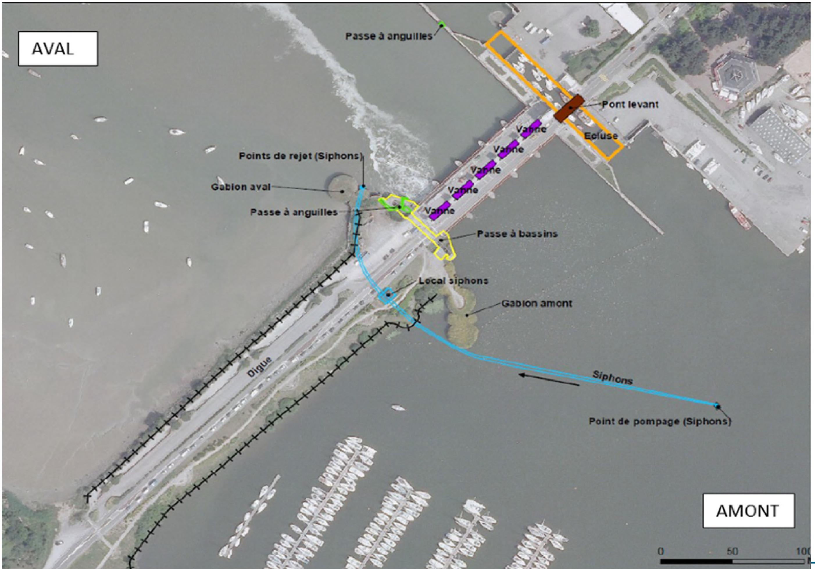
Figure 1 : Vue en plan du barrage et de ses principaux équipements
