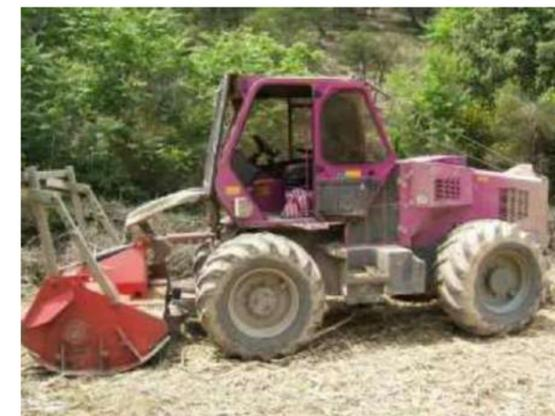
Figure 35 : Exemple de tracteur équipé d'un broyeur forestier
