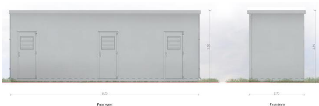
Façades d'un poste de livraison (Source : étude d'impact, CESAME, juin 2023)
