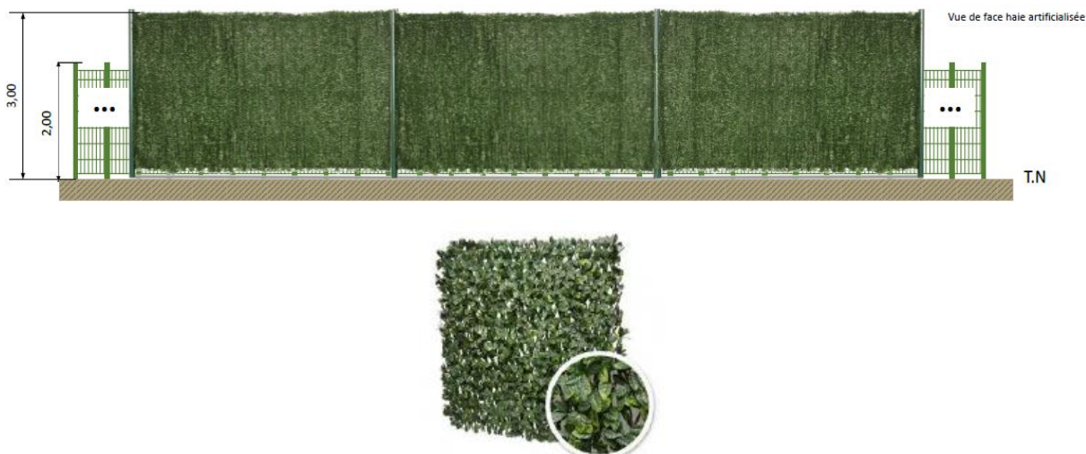
Figure 66. Haie artificialisée le long de la clôture extérieure (source : CORSICASOLE)
