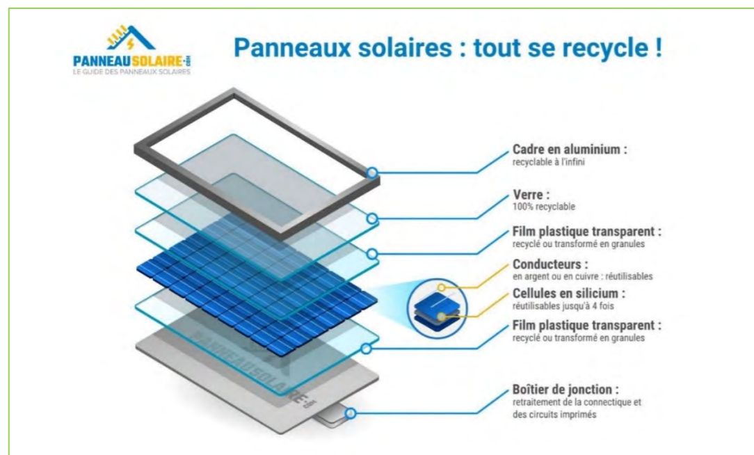
Figure 27 – Recyclage des modules photovoltaïques (source : Panneausolaire.com)
