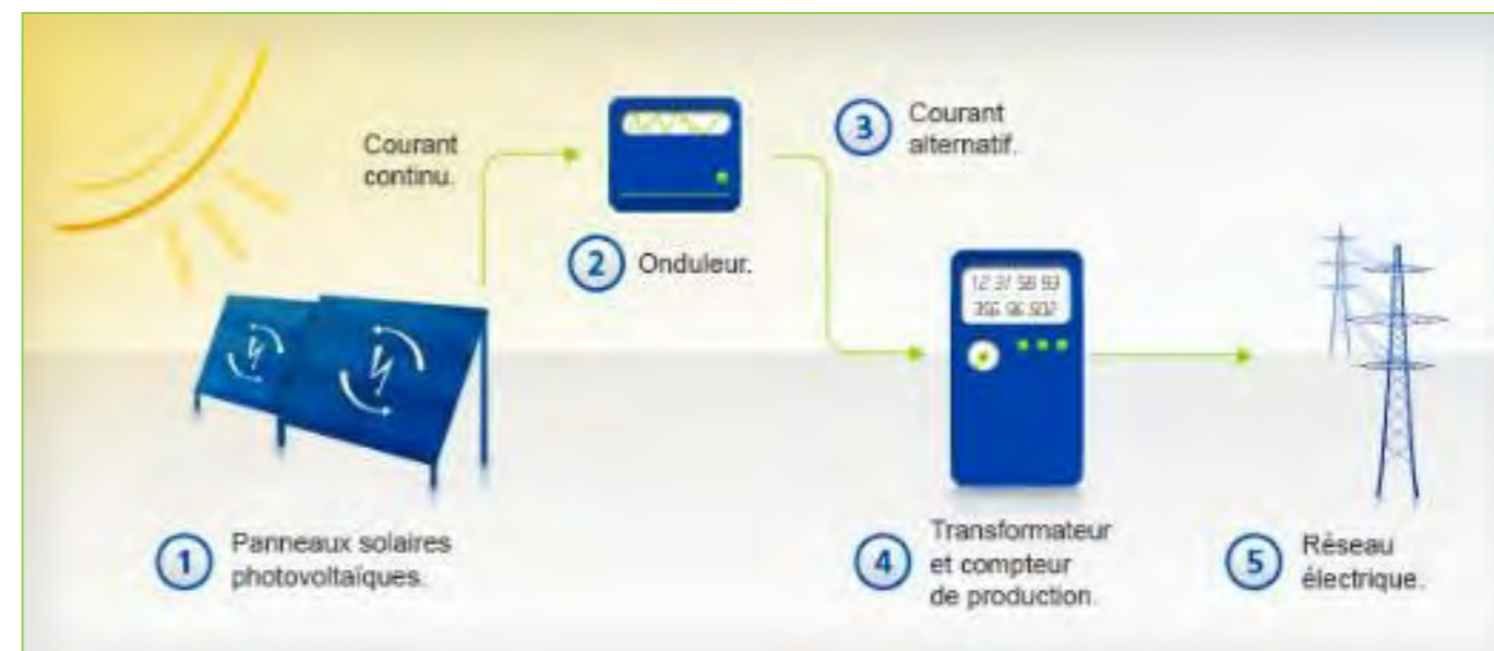
Figure 10 - Schéma descriptif du fonctionnement des modules solaires (source : Guide méthodologique de l'étude d'impact d'une centrale photovoltaïque au sol, 2011)
