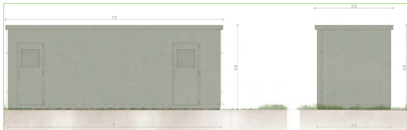
Figure 19 – Vue extérieure d'un poste de livraison (source : PHOTOSOL)
