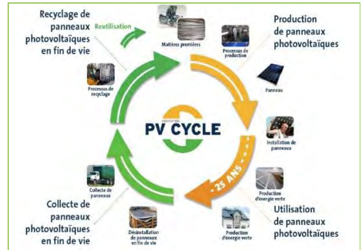
Figure 26 – Analyse du cycle de vie des panneaux cristallins (source : PV Cycle devenu Soren en 2021)
