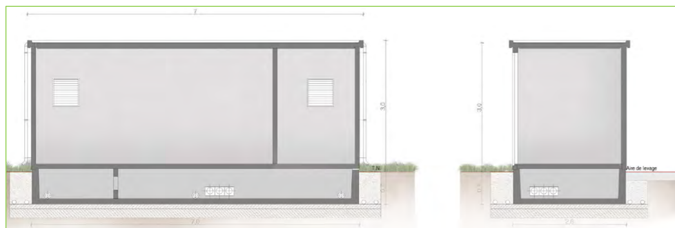
Figure 20 – Coupes d'un poste de livraison (source : PHOTOSOL)
