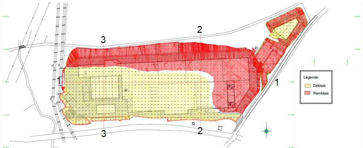
Figure 74 : Plan de terrassement / équilibres des déblais/remblais.
