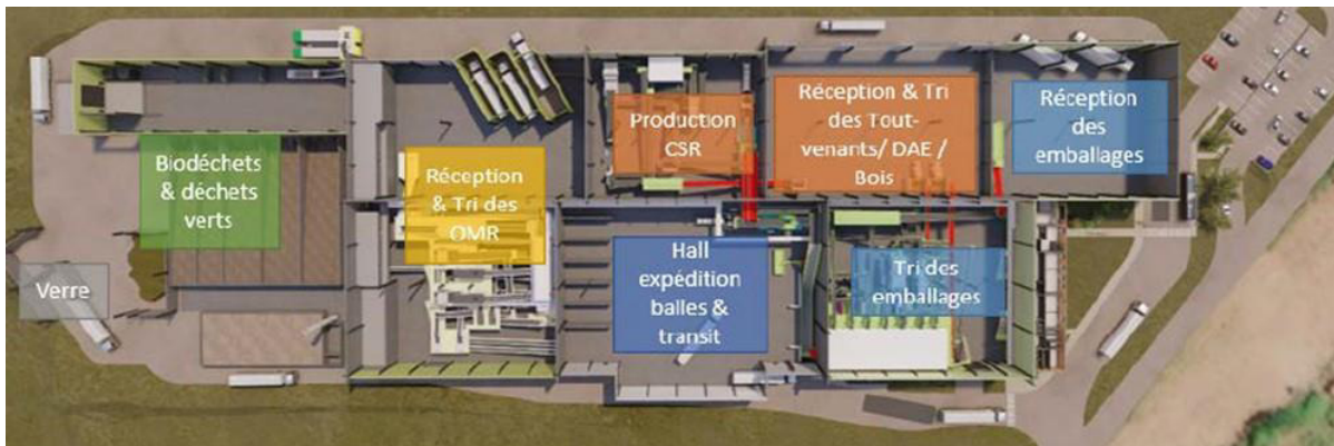
Illustration non définitive : vue éclatée intérieur bâtiment
