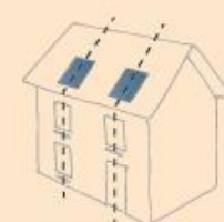
Composition en alignement avec les ouvertures de la façade ou du toit
