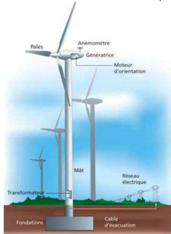
Figure 5: Représentation schématique d'une éolienne (Source : EDF)
