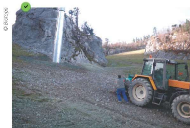
En milieu difficile d'accès, une petite cuve est installée à l'arrière d'un tracteur pour faciliter l'ensemencement.
