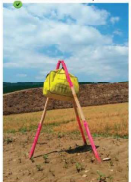
Illustration 27 : Exemple d'un kit anti-pollution isolé du sol (Source : Guide des bonnes pratiques environnementales - Protection des milieux aquatiques, AFB 2013)
