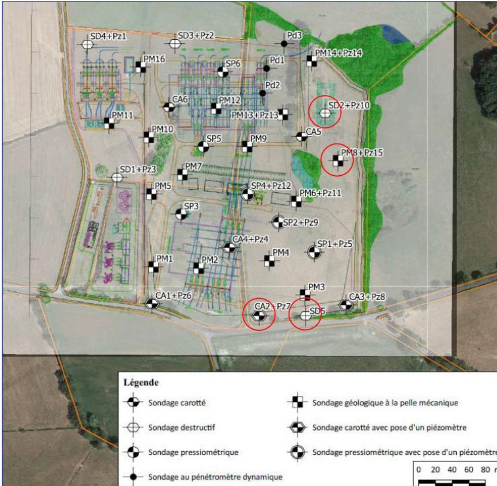
Localisation des essais de perméabilité d'avril 2023 (Source : Géotec)
