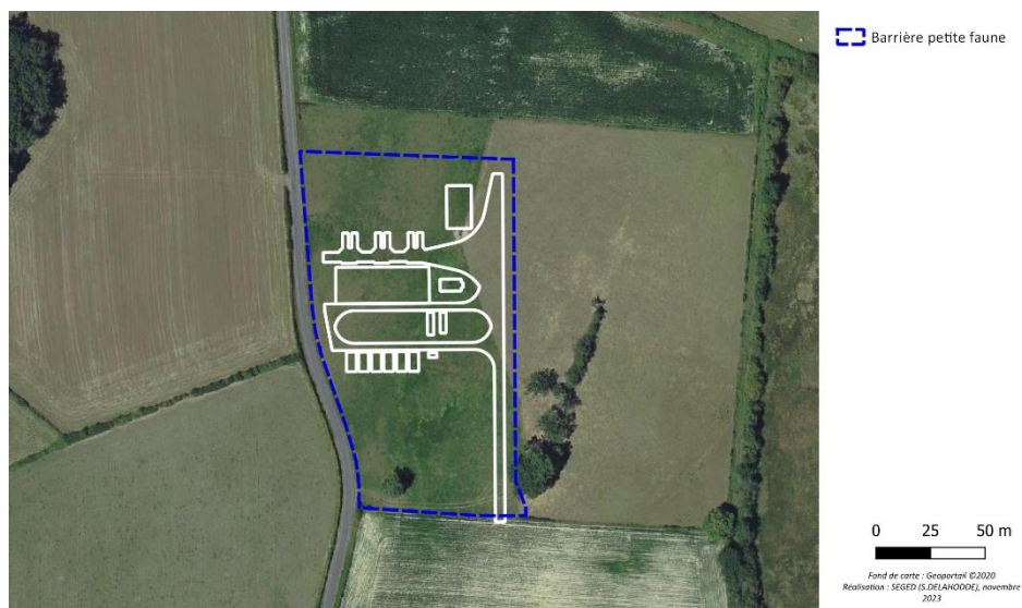
Mise en place de la barrière petite faune tout le long de l'emprise
