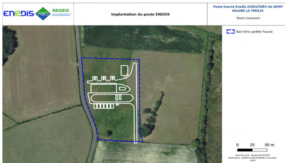
Mise en place de la barrière petite faune tout le long de l'emprise
