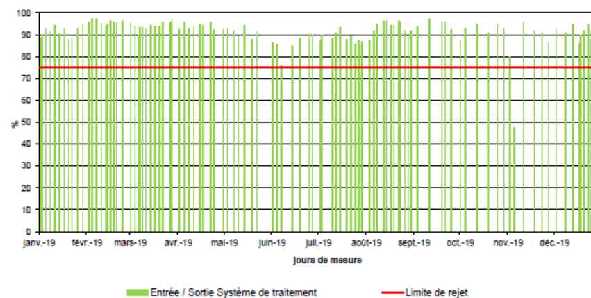
DCO : rendement du système de traitement les jours de mesures
