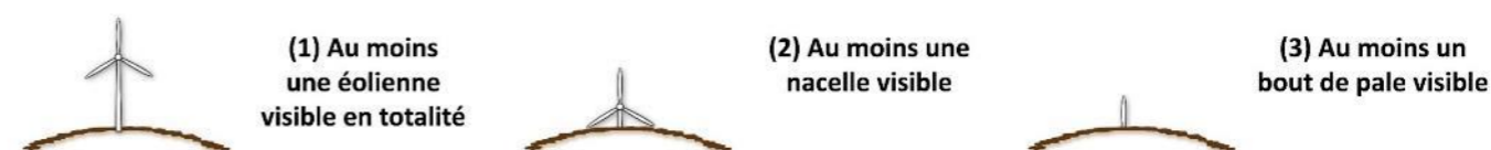
Figure 28 : Les différentes classes de visibilité en fonction de la portion d'éolienne visible
