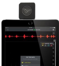
Photographie 3 : Echo-Meter Touch (EMT) de Wild life Acoustics
