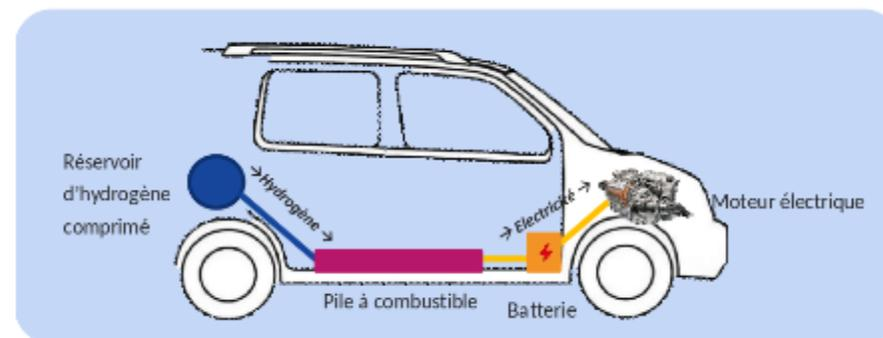
Figure 99: Schéma d'un véhicule hydrogène
