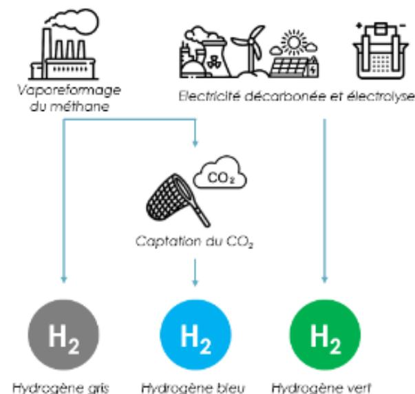
Figure 98: Schéma de la production d'hydrogène
