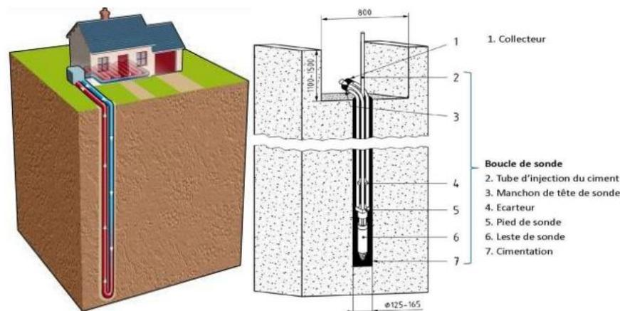
Figure 89 : Illustration du fonctionnement de la géothermie sur sonde (BRGM)
