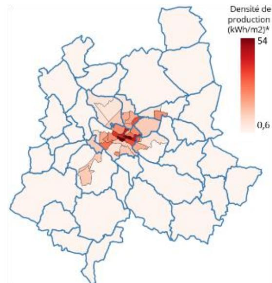
Figure 64: Cartographie à maille IRIS du potentiel PV sur toiture (kWh par m<sup>2</sup> de l'IRIS)
