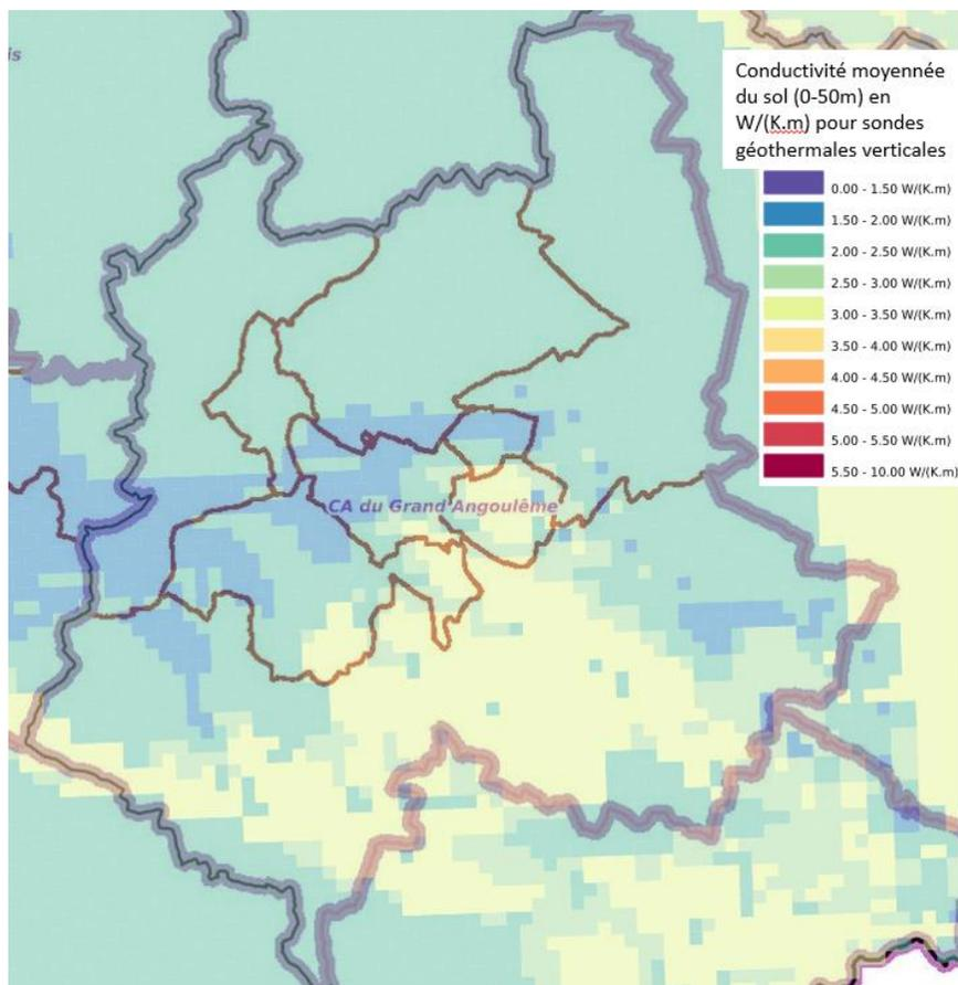
Figure 92 : Conductivité moyennée du sol (0-50m) pour géothermie sur sonde
