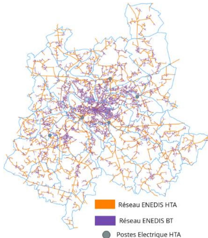
Figure 183 Cartographie du réseau de distribution d'électricité
