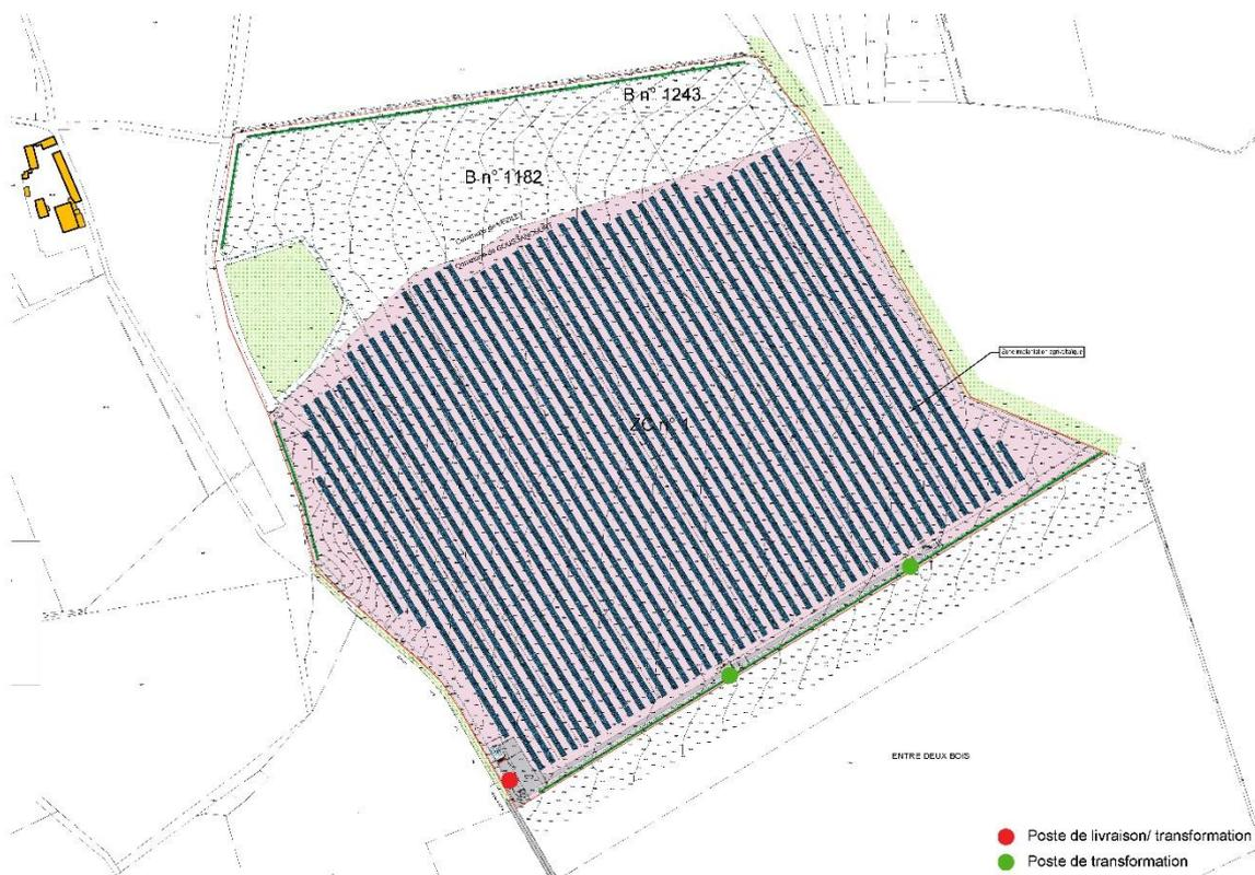
Figure 9 - emplacements des postes électriques
