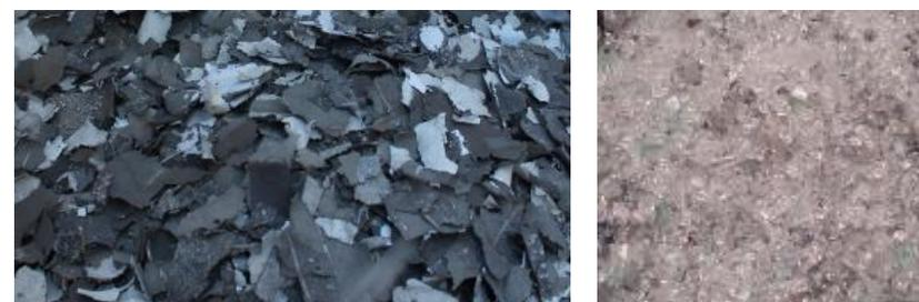
Figure 94 : Fragments de silicium et granulés de verre (source : Soren, 2015)
