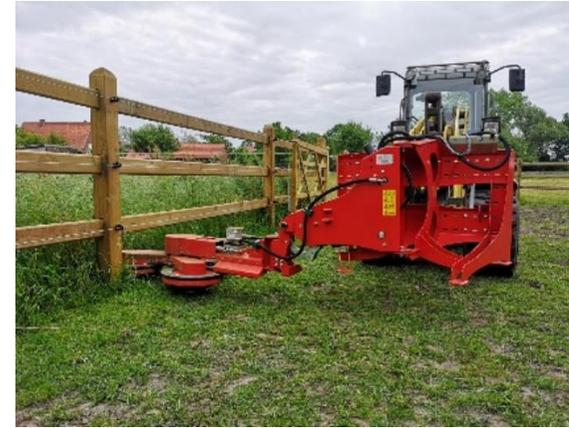
*Figure 91 - Exemple d'entretien de clôture à l'aide d'une faucheuse escamotable (Crédit : PM Environnement)*
