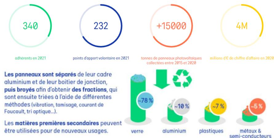
Figure 93 : Le traitement des panneaux photovoltaïques (source : Soren, 2022)
