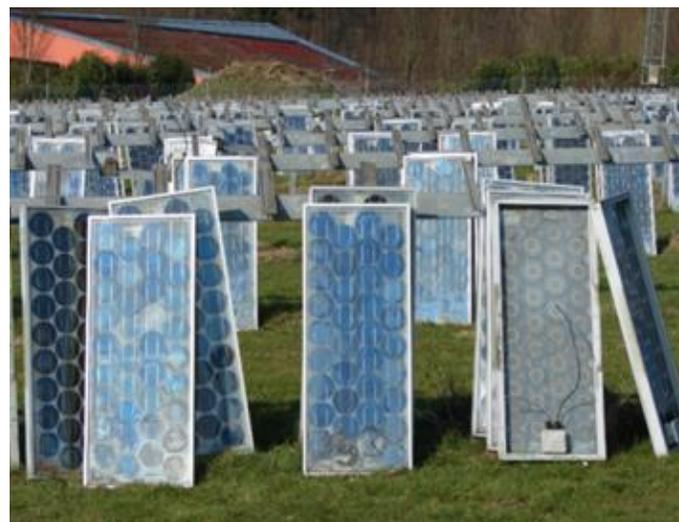
Figure 92 : Panneaux photovoltaïques en fin de vie (source : Soren, 2015)
