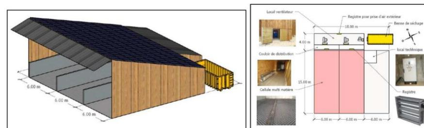
Figure 118 : Schéma d'architecture du séchoir (Source : BASE avril 2023)
