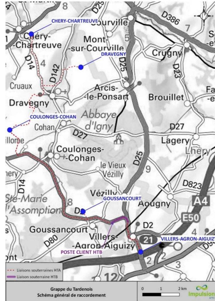
Carte 3 : Schéma général de raccordement de la Grappe du Tardenois (source : IMPULSION, 2023)
