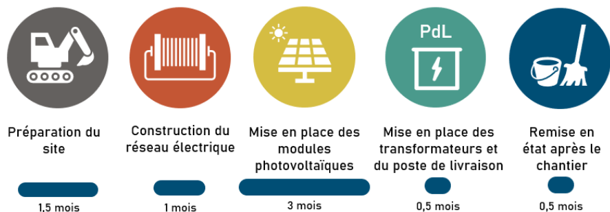
Figure 1 : Durées approximatives et phases de travaux de construction d'un parc agrivoltaïque
