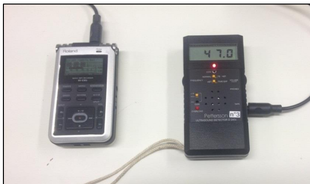
Figure 1 : Roland -05 (enregistreur numérique) et D240X (Détecteur à ultrason)
