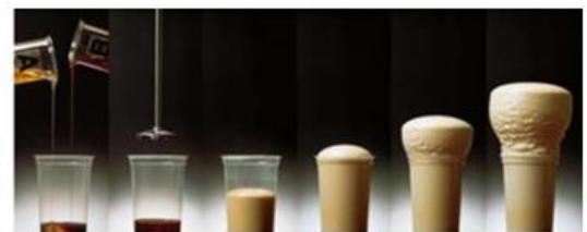
La mousse de polyuréthane est obtenue par le mélange de 14 composants : Polyol, Isocyanate, Agent gonflant, Eau, Ignifugeant, Silicone, Azote, catalyseurs des réactions de polymérisation...
