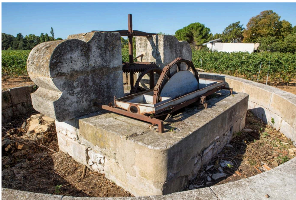
Castelnau-le-Lez (Hérault) ; noria du Clos de l'Armet, mécanismes en fonte.
