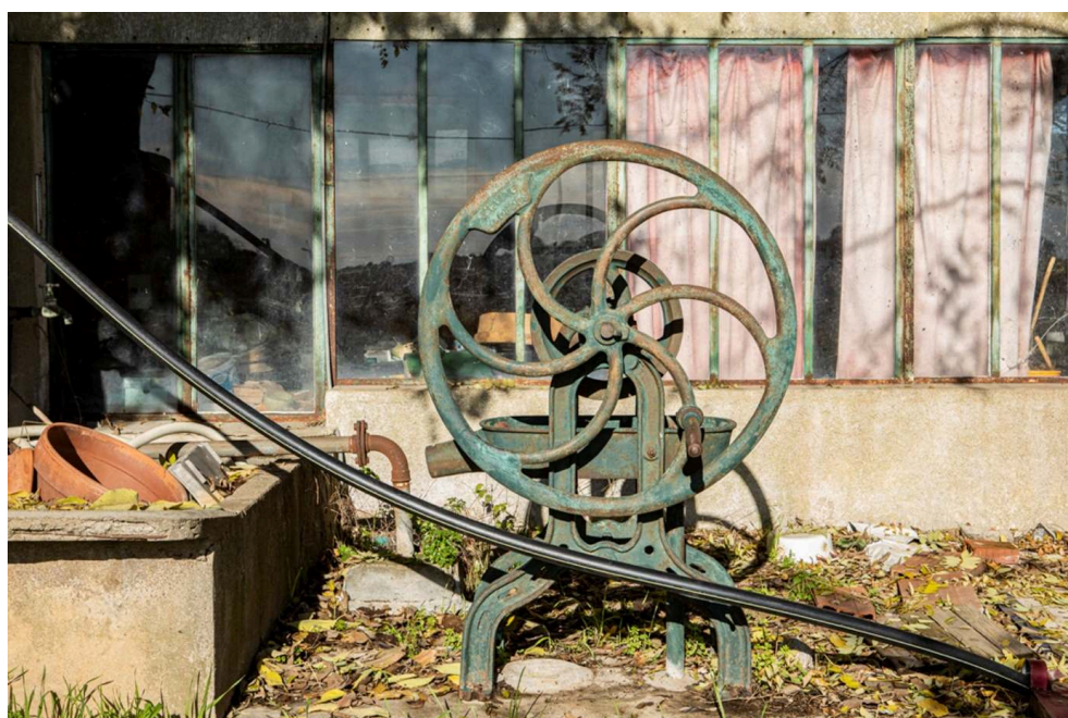
Castelnau-le-Lez (Hérault) ; pompe à chapelet du constructeur Gillet (Castres).
