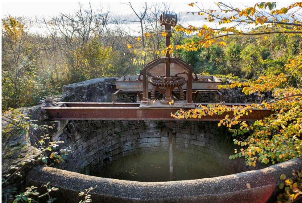
Castelnau-le-Lez (Hérault) ; noria installée sur un puits largement ouvert.
