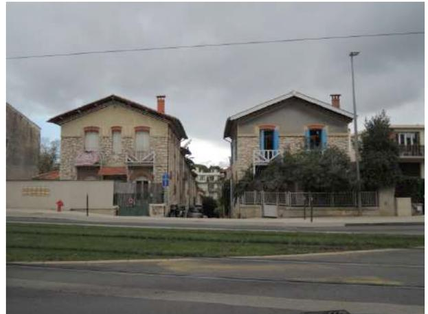
*Le rehaussement de la toiture par la mise en place d'une isolation par l'extérieur ferait disparaître la modénature et la composition du couronnement qui caractérisent ce type de bâtiments.*
