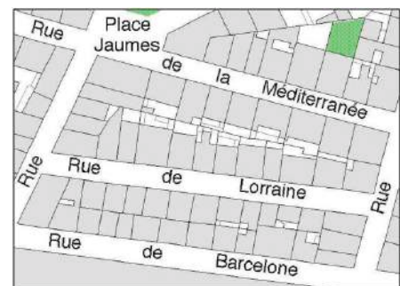
Bâti accolé dos à dos
