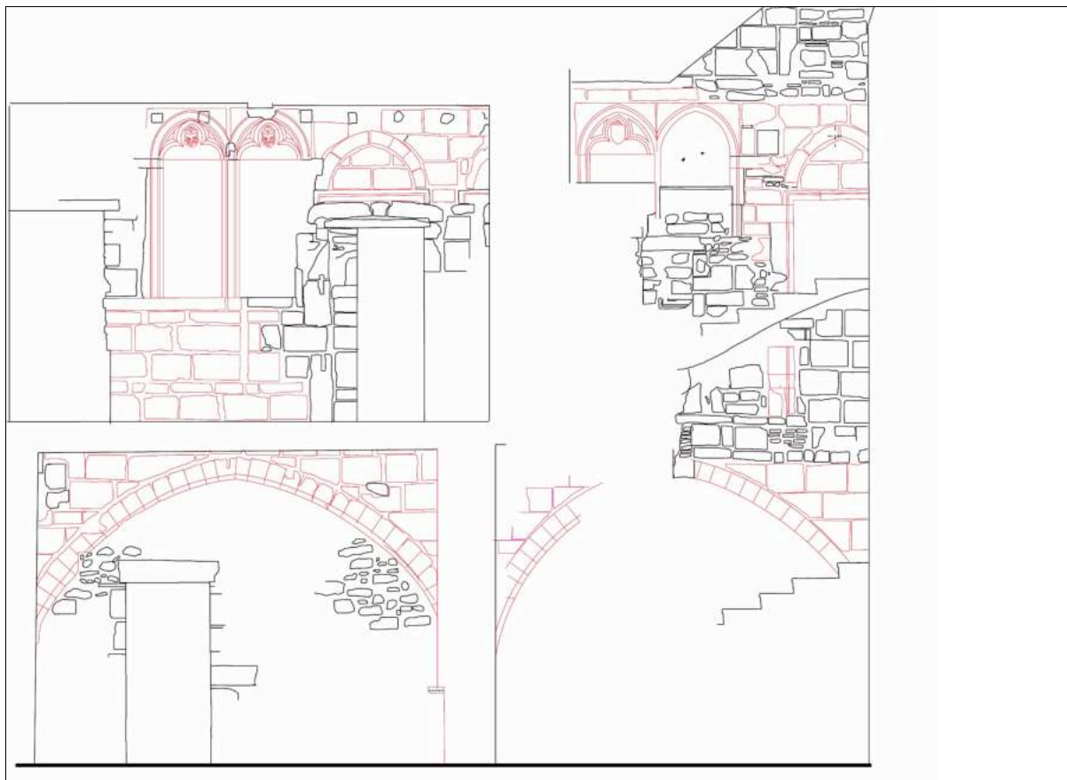
Fig. 42 10, rue de l'Université — vestiges de fenêtres géminées et d'anciennes portes médiévales dans la cage d'escalier
