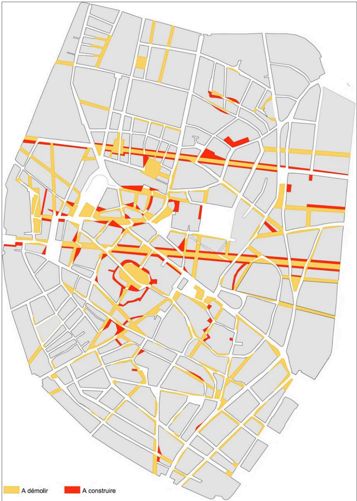
Les alignements de Fovis et Bouet transcrits sur le plan de 1816 – 1825 montrent l'ambition de percées est-ouest et de transformations radicales du tissu ancien de l'Ecusson.
