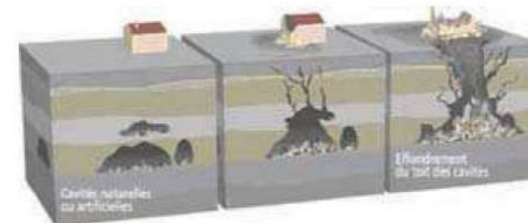
Figure 234 : Affaissements dus à la présence de cavités souterraines et d'anciennes carrières
