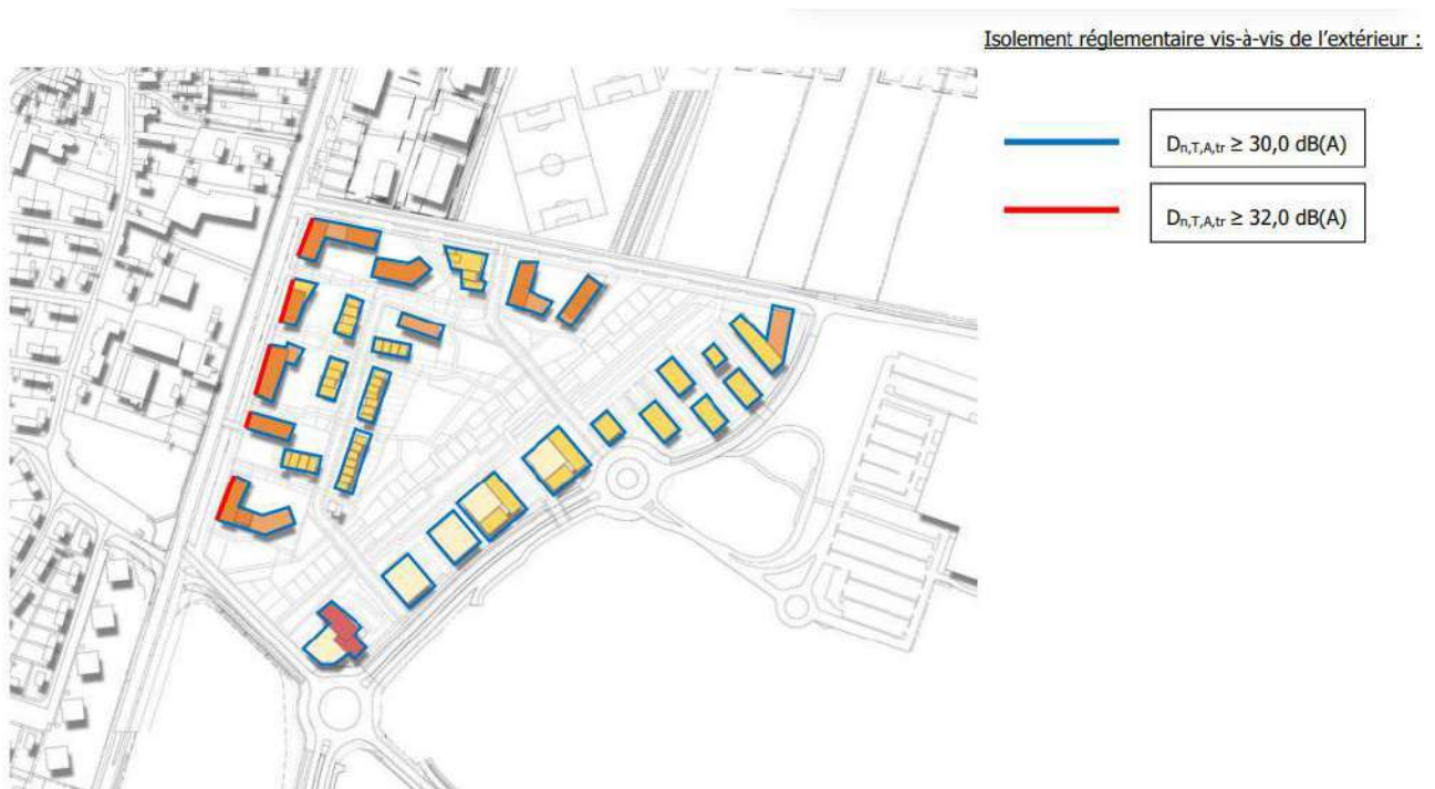
Figure 16 : Isolation réglementaire des façades
