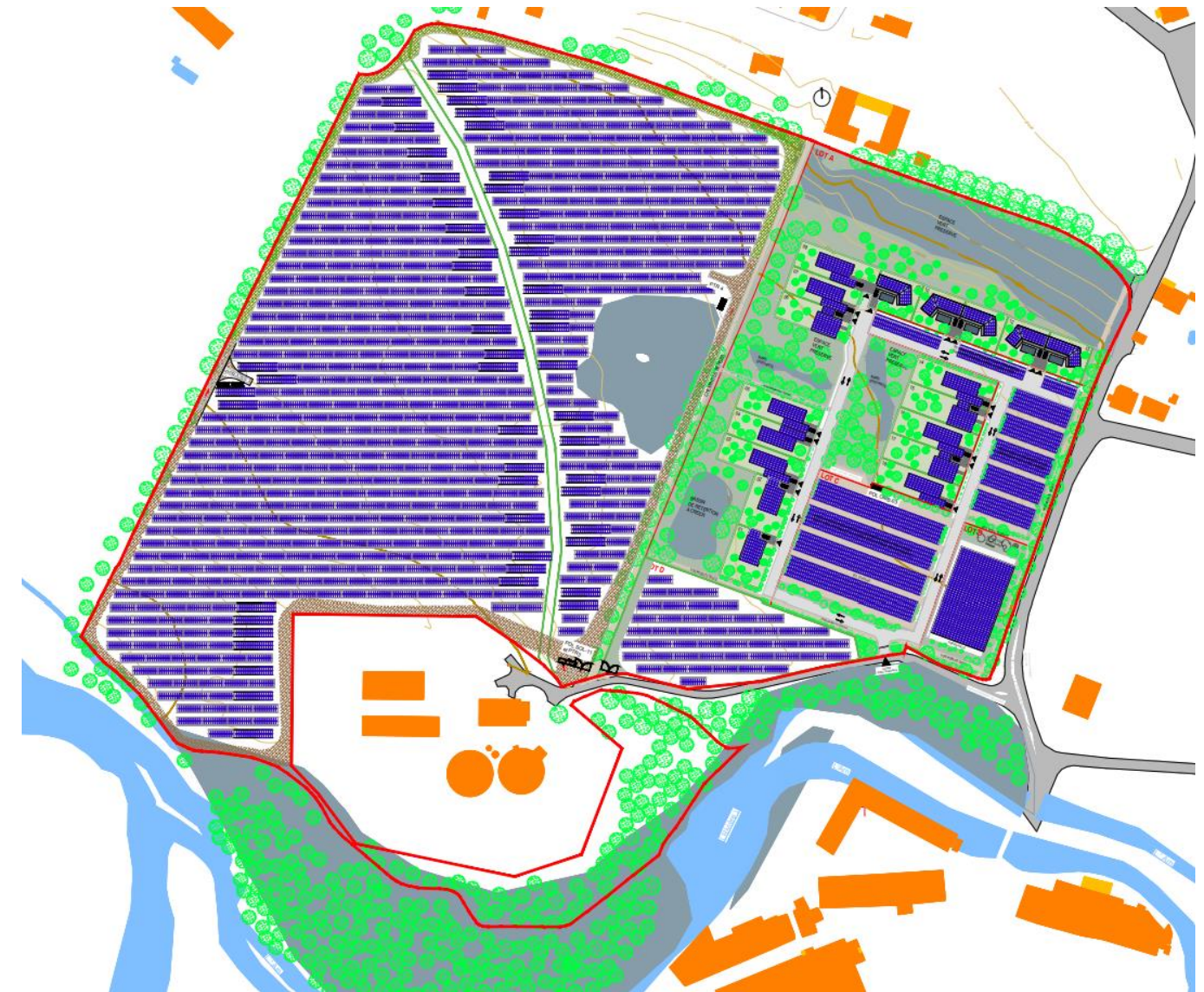
Figure 2 : Orientation du bâti et de la centrale photovoltaïque au sol pour un ensoleillement optimal (source WATT&CO Ingénierie)
