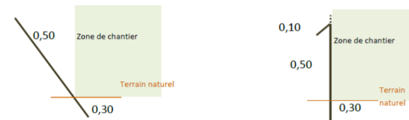
Figure 72 : Principe et caractéristique des clôtures contre l'intrusion des batraciens
