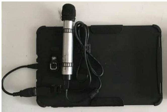
*Tablette (Tab A) reliée à un micro Dodotronic modèle Ultramic UM250k*
