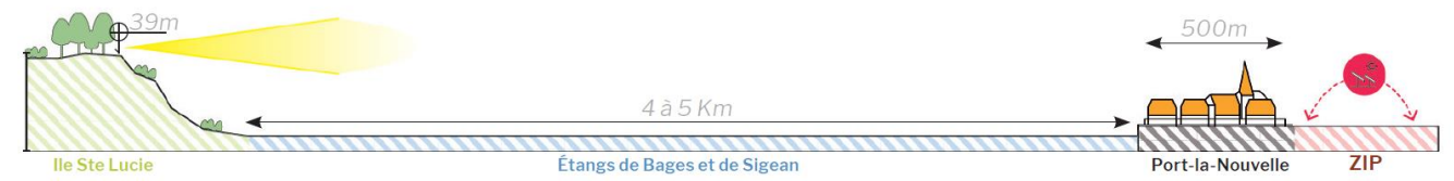
Figure 25 : Coupe de principe illustrant la visibilité sur la ville de Port-la-Nouvelle : la distance, le relief, la hauteur bâtie ne permettent pas la visibilité sur la ZIP depuis l'île Sainte Lucie.
