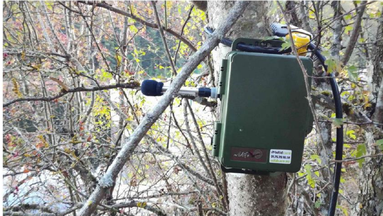
Figure 13 : Pose de SM4Bat+ pour les inventaires acoustiques au sol (Source : Y. RONCHARD)
