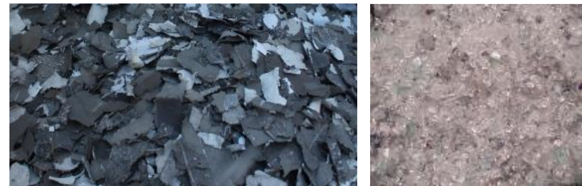
Figure 83 : Fragments de silicium et granulés de verre (source : Soren, 2015)
